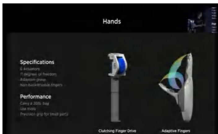
图 13：Optimus 灵巧手设计方案
