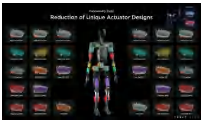
图 17: Optimus 共搭载 28 个执行器组件
