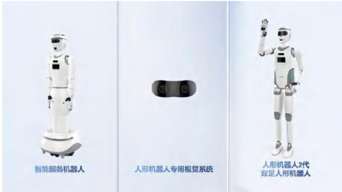
ViHero 创世纪版发布后，伟景机器人秉承“为梦想、为世界打造一款真正的智能机器人”发展理念，继续研发更为复杂的双足机器人，该款机器人具备像人一样通过双足行走，能够根据不同路面状况调整自身各关节的转角，实现在非平整路面或有障碍物等复杂路面上的步态切换，灵活自如地完成躲避障碍物、跨越沟壑、上下楼梯、爬坡等任务。
